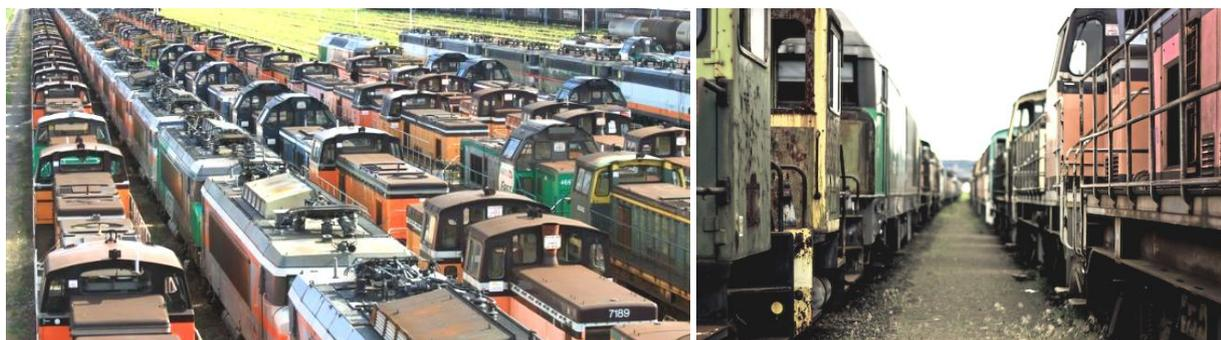
Ces matériels, garés en bon état, doivent avant remise en service subir une révision lourde qu'il est nécessaire de provisionner. Par contre, s'il fallait démanteler ces engins, il serait nécessaire d'établir un protocole tenant compte de l'amiante qu'ils contiennent et cela renchérisse le coût de ce démantèlement. Donc la mise à la retraite de ce parc constitue une charge bilancielle qui sera fatalement à prendre en compte.
